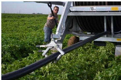
Mettre le tube PE dans la position souhaitée à l'aide du bras d'orientation hydraulique.
