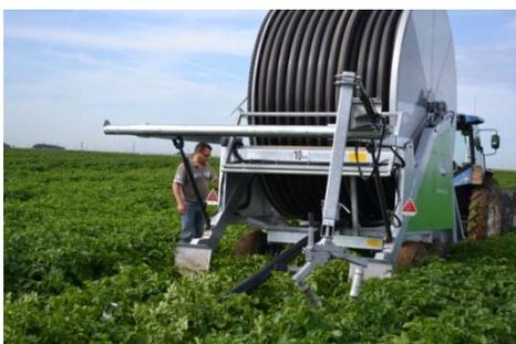
Placer le bras hydraulique avec le guidage à rouleau ouvert au-dessus du tube PE et le baisser ensuite sur le tube PE.
