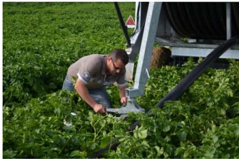
Fermer le guidage à rouleau et bloquer avec la goupille à ressort.
