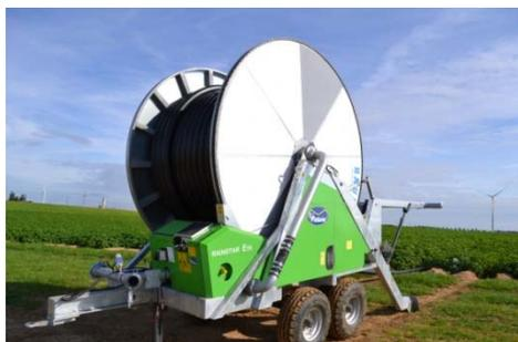
Descendre les béquilles droites et gauches régulièrement à l'aide de l'hydraulique de commande. Faire attention à ce que les bêches plient vers le bas jusqu'à la butée. Afin d'atteindre une fixation optimale, les béquilles doivent être baissées jusqu'à la position finale. En cas d'un sol très dur les béquilles doivent être baissées dans un trou, qui a été creusé auparavant.
