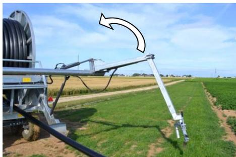
Après que le tube PE a été déposé, ouvrir le guidage à rouleau et relever le bras d'orientation, afin que la zone soit libre pour l'arrivée du traîneau.
